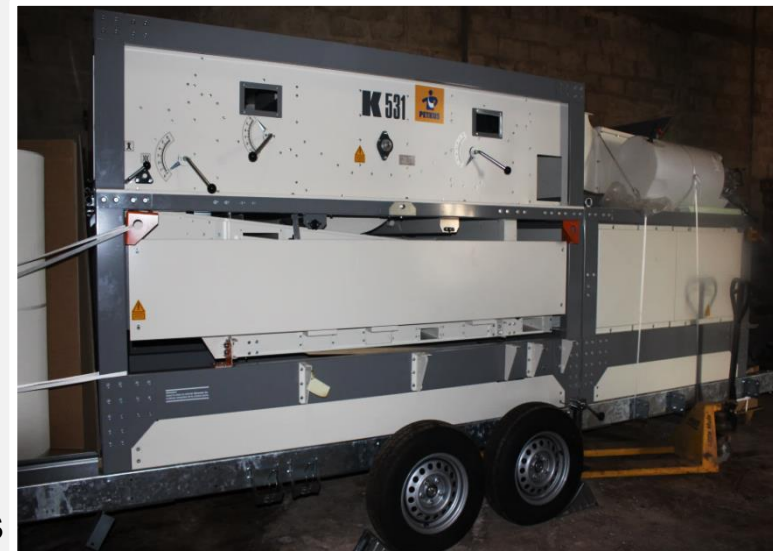
PPP: Machine mobile de nettoyage-calibrage & traitement de semences
