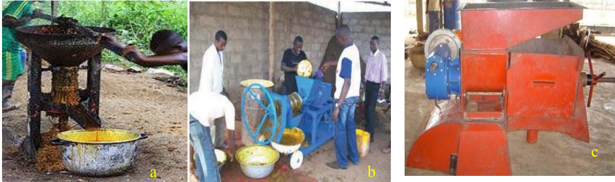
Différents types de presses (a : Presse manuelle, b : Presses motrices ; modèle ATI et c : modèle OPC Caltech)
