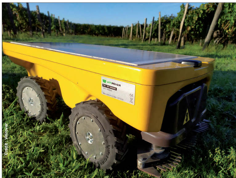
Grâce à l'action du petit robot totalement autonome, l'herbe est tondu en permanence et la renaturation du sol se réalise en continu.
