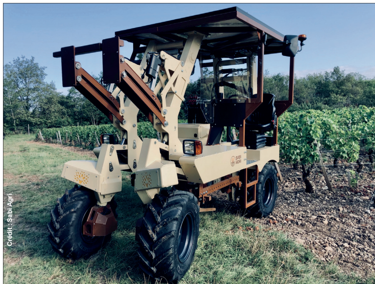
L'enjambeur 100 % électrique Alpo peut profiter de la Zilus Box. Le viticulteur est alors déchargé de la vitesse et de la direction. Il n'a plus qu'à se concentrer sur les outils.
