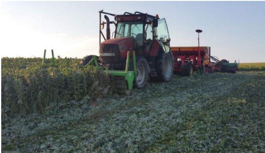
Un rouleau à lames devant le tracteur, le semoir et un rouleau pour « rappuyer » : 3 opérations en 1 passage !
